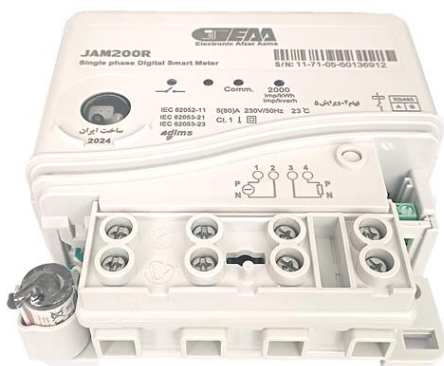
شکل ۶: محل نصب باتری خارجی در کنتور JAM200R (پوشش محل نصب باتری خارجی باید شکسته شود)
